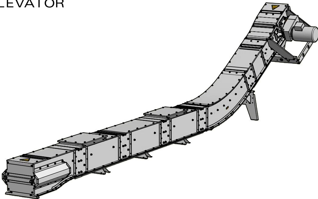
Наши машины предназначены для использования вне помещений. Мы используем только оцинкованный стальной лист и соединяем части клепанием и ввинчиванием, чтобы поверхностный слой оставался нетронутым. Края согнуты вниз, швы и стыки накладываются внахлест, а многие детали штампованные для предотвращения проникновения воды. Наиболее уязвимые швы также уплотнены резиновыми планками или силиконом. Изделия из ассортимента H-LINE предназначены для установок с интенсивной эксплуатацией круглый год.
